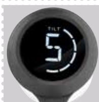
При чрезмерном наклоне блендера двигатель автоматически выключится
